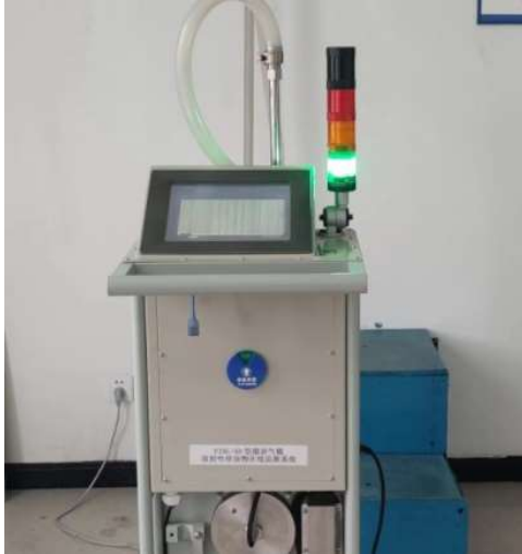
c) 烟囱废气在线排放监测系统
