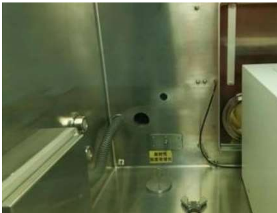
a) 箱体内放射性固废收储口
