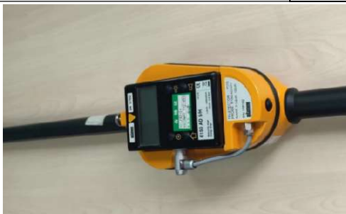
a) X-γ 辐射剂量巡测仪
