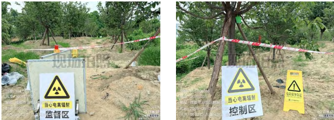
图 3-3 野外探伤现场“两区”边界警示标牌及警示线
