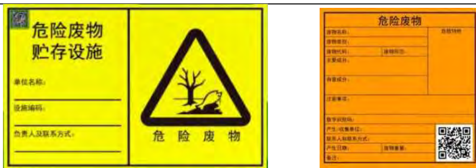
图 10-2 危险废物警告标志牌、危险废物标签
