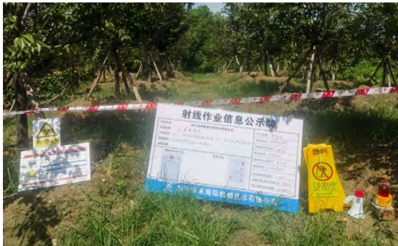
图 3-4 野外探伤现场安全信息公示牌
